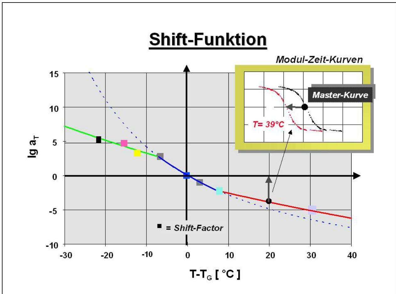
Fig. 7: Temperaturfunktion der Relaxationszeiten; Referenztemperatur  $T_{\text{Ref}} = T_G = -19^\circ\text{C}$ .
