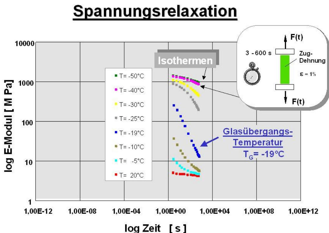
**Fig. 5:** Messung von Relaxationsisothermen eines typischen Fluorelastomeren.
