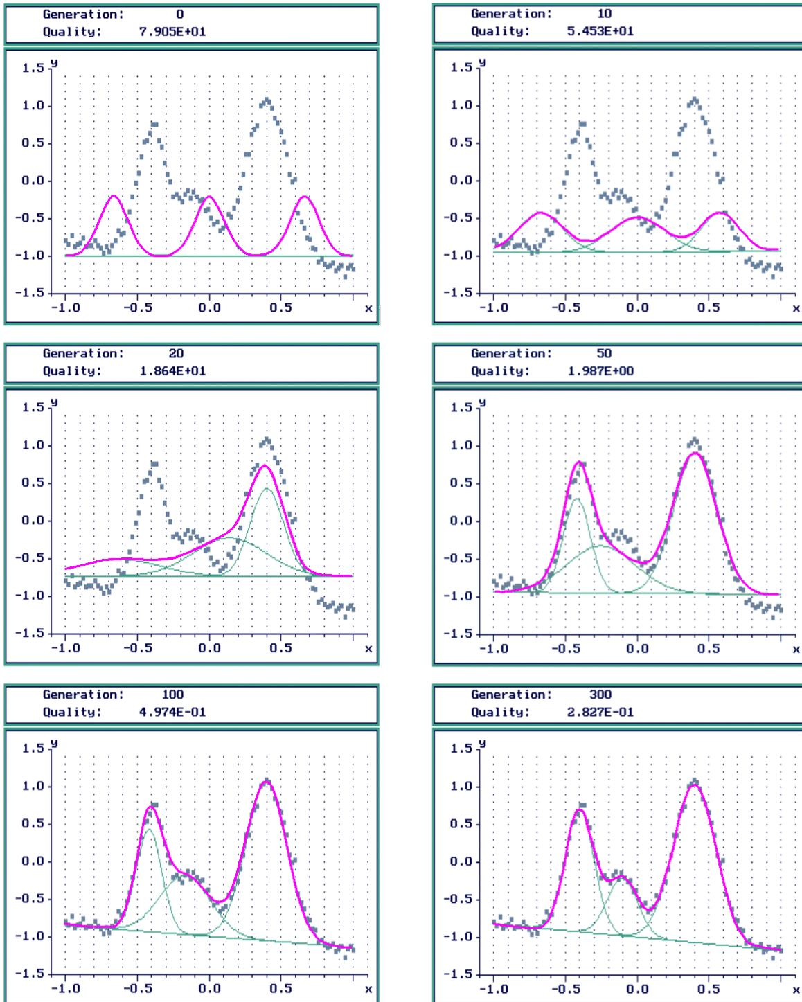
**Fig. 2:** 'Ahnengalerie' der Anpassung einer aus der Summe dreier Gaußfunktionen und einer linearen Funktion bestehenden Funktion an eine Menge von Datenpunkten. Gezeichnet sind die Teilfunktionen sowie die Summenfunktion.
