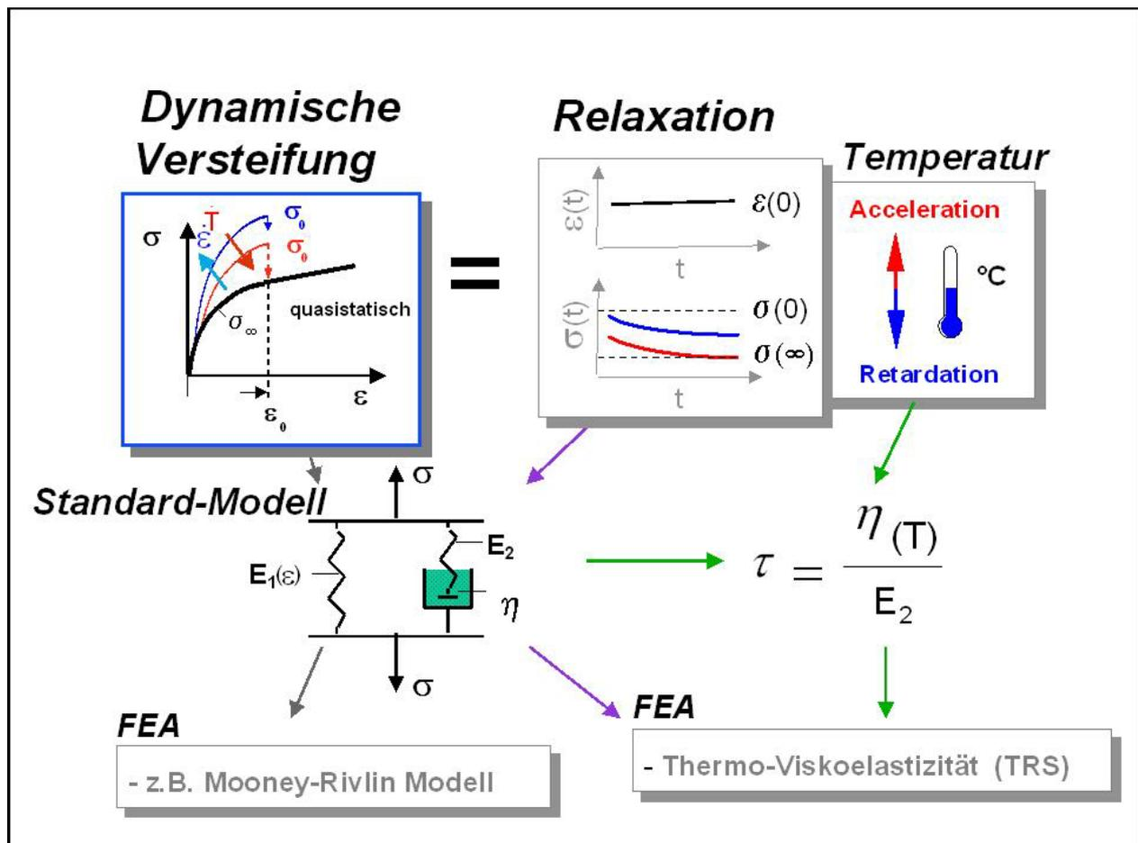
**Fig.4:** Mathematische Modellierung der Relaxation. Das Standard Modell der Viskoelastizitätstheorie kann viele der beobachteten Relaxationsphänomene bei Gummiwerkstoffen qualitativ gut beschreiben.
