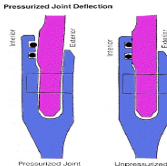
**Fig. 9:** Fügestelle zwischen zwei Segmenten der Feststoffrakete mit den Dichtringen (aus [12] ).
