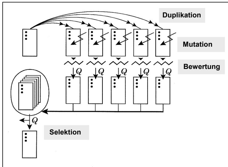
Fig. 1: Ablaufschema einer (1, 5)-ES, nach [3]
