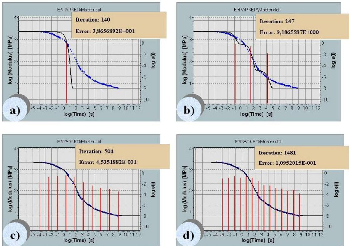
**Bild 8:** Vergleich von experimenteller Masterkurve und Fitfunktion bei Berücksichtigung unterschiedlich vieler Maxwell-Elemente, respektive Relaxationszeiten: **a)** nach dem Standardmodell; **b)** Modell 3'ter Ordnung; **c)** Modell 10'ter Ordnung; **d)** verallgemeinertes Maxwell-Modell 15'ter Ordnung. Zusätzlich zur Fit-Funktion (schwarze Kurve) ist auch das Linienspektrum der Relaxationszeiten gezeigt (rote Linien).
