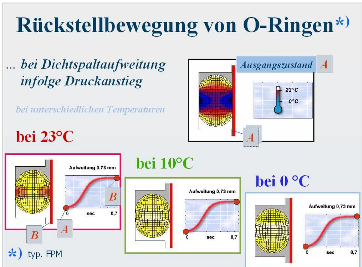
**Fig. 10:** Gezeigt wird die Konfiguration eines FPM O-Ring jeweils am Ende einer vorgegebenen Deckelbewegung ( Aufweitungs-Charakteristik: A → B ) bei verschiedenen Temperaturen. Unter [12] sind Computeranimationen der hier dargestellten Fälle einsehbar.
