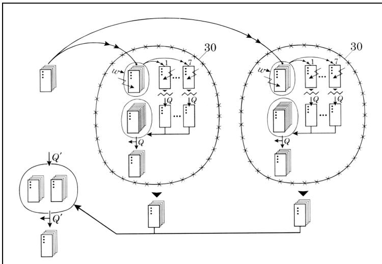
**Fig. 3:** Ablaufschema einer  $(1, 2(4,7)^{30})$ -ES, aus [3]
